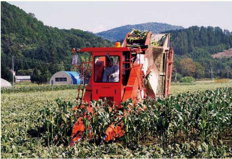
9月1日からは、新たに導入された自走式ハーベスターでの収穫作業が行われました。この機械は茎を2列分一気に刈ることができ、収穫作業の効率化が図れるため、他の作物の収穫作業に充てられる時間が増えます。また、天気の良い日に一気に収穫を終わらせることができるため畑を傷めることがなく、次の小麦の植え付け
