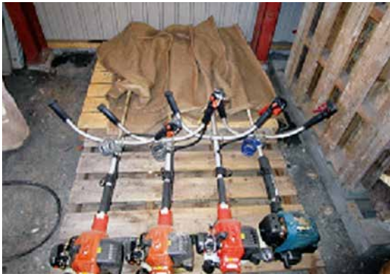
写真3 刈払機を地面に置き、 刈刃も「むしろ」で覆った安全対策
