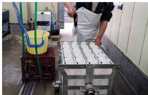
写真8 ブラシを回転させながら上下に動かして汚れを落とす
